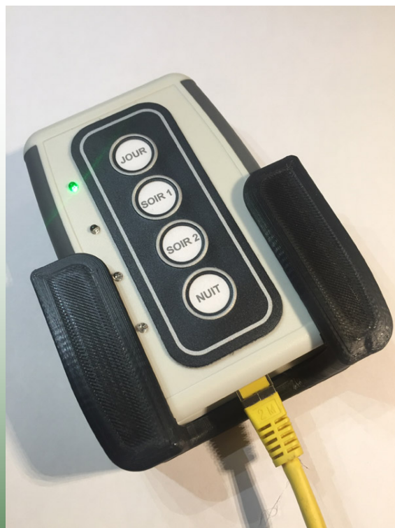
Boîtier ergonomique : 120 x 75 mm Support mural imprimé en 3D
